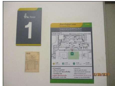
รูปที่ 2-56 แผนผังอาคาร ที่ระบุเส้นทางหนีไฟ อุปกรณ์ดับเพลิง และเบอร์โทรศัพท์ฉุกเฉิน
